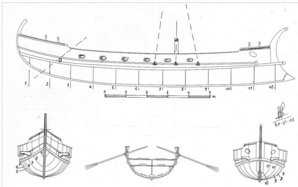
**fig. 12** Ricostruzione della barca C di Pisa localizzata a San Rossore. Vista di fianco da destra e sezioni trasversali (da M. Bonino, *Ricostruzione della barca C di Pisa S. Rossore*).
